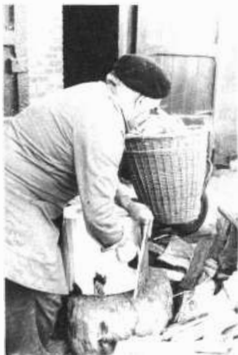
Fig. IX 33 : Ontschorsen van de afgezaagde bollen. Foto bij de gebroeders Luyx te St.-Gillis-Waas.
