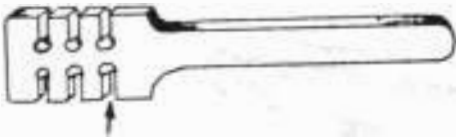
Fig. VI 7 : breedte van de gleuf volgens dikte van het lemmer
