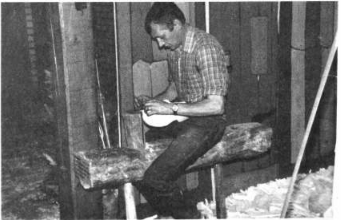
Fig. VII. 23 : Schrapen van een klomp met een stuk glas. Persoon zit op een schraappaardje.
