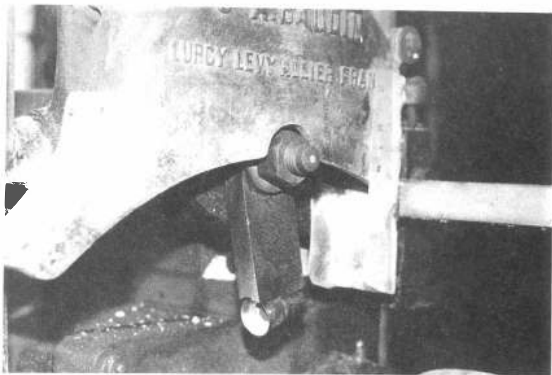
Fig. IX 37 : Detail van de kapbeitel welke in feite een kop pot was.
