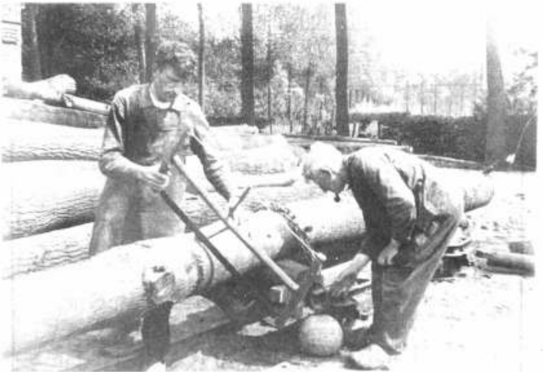
Fig. IX 8a : Het vastleggen van de boomstam op een wagentje dat op rails loopt tot aan de zaagmachine. Ondertussen wordt de boom uitgestapt voor het afzagen van de schijven. Dit alles bij de firma Lippens te St.-Gillis-Waas.
