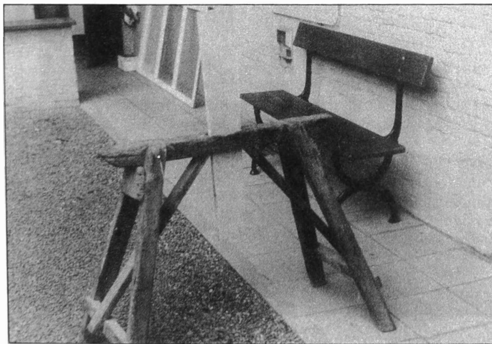
In de gleuf van de schraag zit een verstelbare plank waarop de boorstang rust
